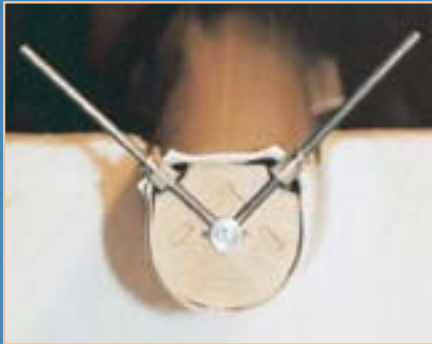
Da ist erst einmal Schluss: Der GfK-Rumpf endet an einem Spant, an dem auch der vordere Stahldraht für das Pendel-V-Leitwerk befestigt ist
