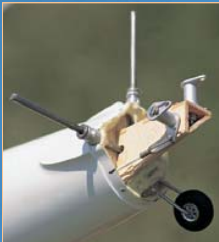
An diesem Spant wird ein Vorbau befestigt, an dem die beiden Umlenkhebel montiert sind. Über diese werden dann die beiden Pendelleitwerkshälften angelenkt
